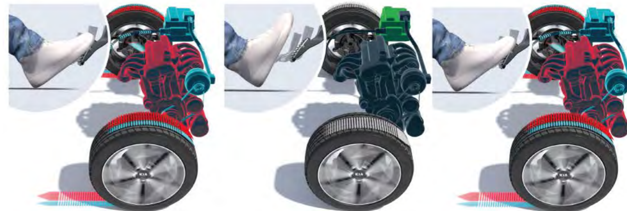
Schemat działania jazdy w trybie żeglowania systemu napędowego Mild Hybrid z inteligentną manualną skrzynią biegów (iMT) i elektronicznie sterowanym sprzęgłem.
